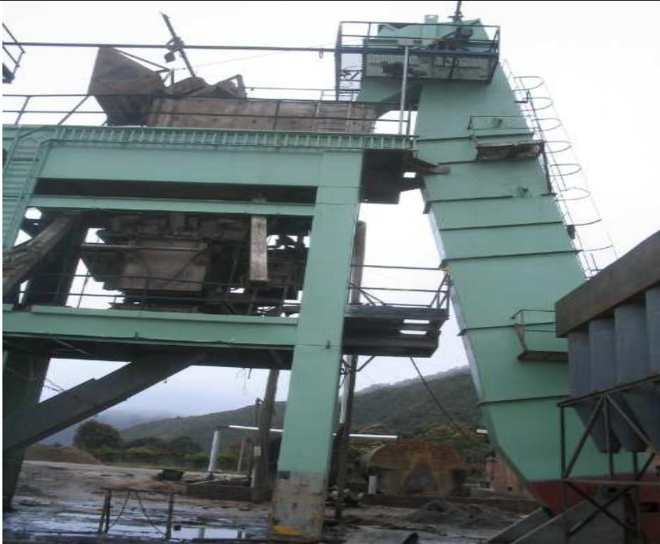
**DESCRIPCION:** Se observa que a la estructura se le realizó el procedimiento de limpieza y pintura.
