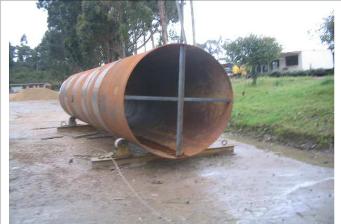
**DESCRIPCION:** Cilindro del Secador de Pétreos, que reemplazará al existente
